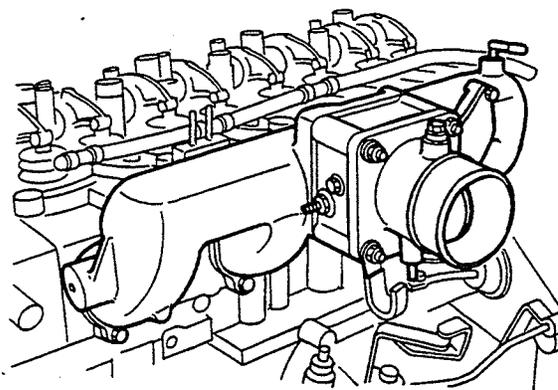
INSTALLING INTAKE MANIFOLD
