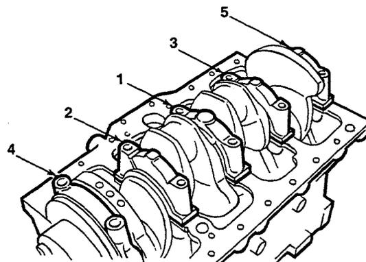
MAIN BEARING CAP TIGHTENING SEQUENCE
