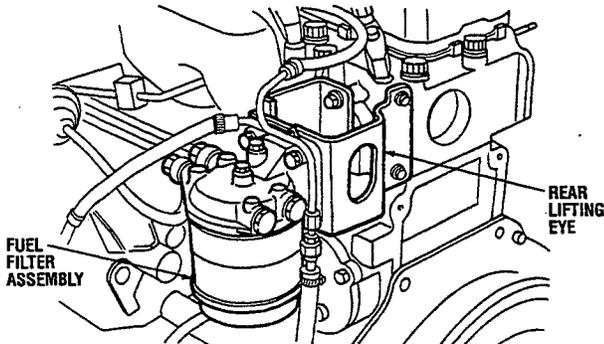
INSTALLING REAR LIFTING EYE & FUEL FILTER ASSEMBLY
