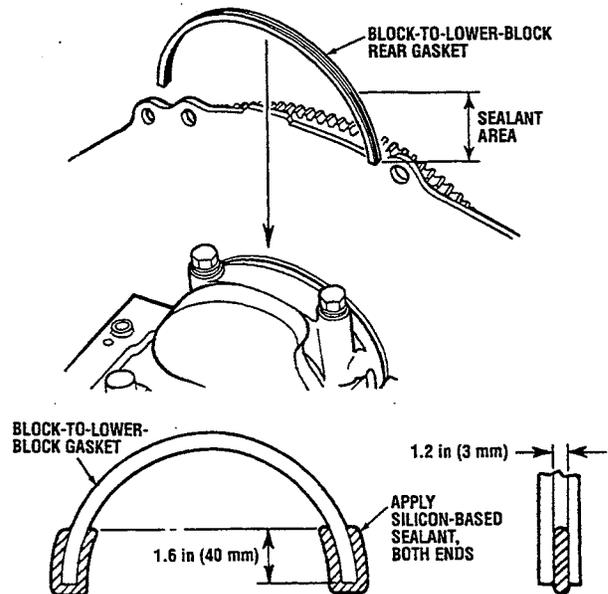
INSTALLING BLOCK-TO-LOWER-BLOCK GASKET (REAR GASKET SHOWN)
