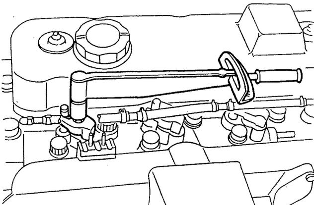
TORQUING THE FUEL INJECTOR HOLDER BRACKET
