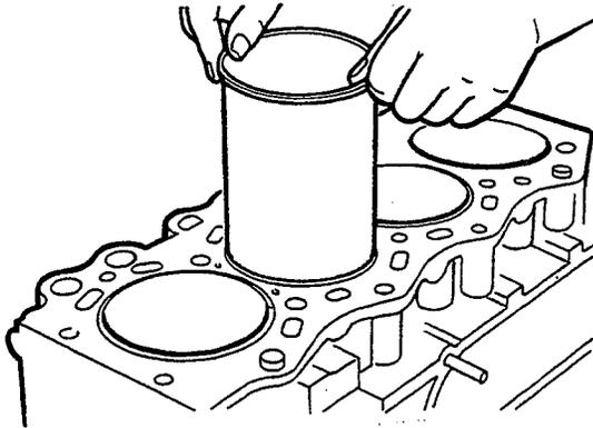
INSTALLING CYLINDER LINERS
