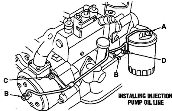
INSTALLING INJECTION PUMP OIL LINE
